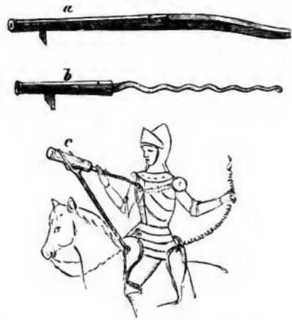
a. Brustbüchse mit gebogenem Kolben. b. Brustbüchse mit gewundenem Griff aus geschmiedetem Eisen. 15. Jhrhdt. (Original im germanischen Museum) Länge: 1 m., Kaliber: 2,3 cm. c. Brustbüchse am Brustharnisch eines Reiters befestigt und schussbereit auf der Gabel liegend. (Nach e. Hdschr. d. 15. Jhrdts.)
